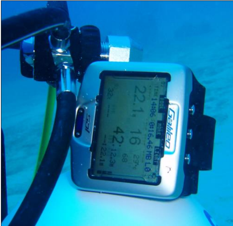
Abb. 22: Der Tauchcomputer Galileo Sol (Fa. Uwatec AG, Spreitenbach, CH) wurde an der ersten Stufe des Atemreglers montiert. Foto: Brebeck
