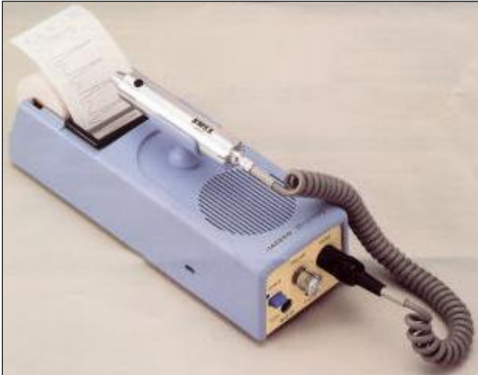
Abb. 16: Das Hadeco ES-1000SP11 angeschlossen an den Schallkopf 5M5S mit welchem die Gefäß-Doppleruntersuchungen durchgeführt wurden. entnommen von www.kdd1.com
